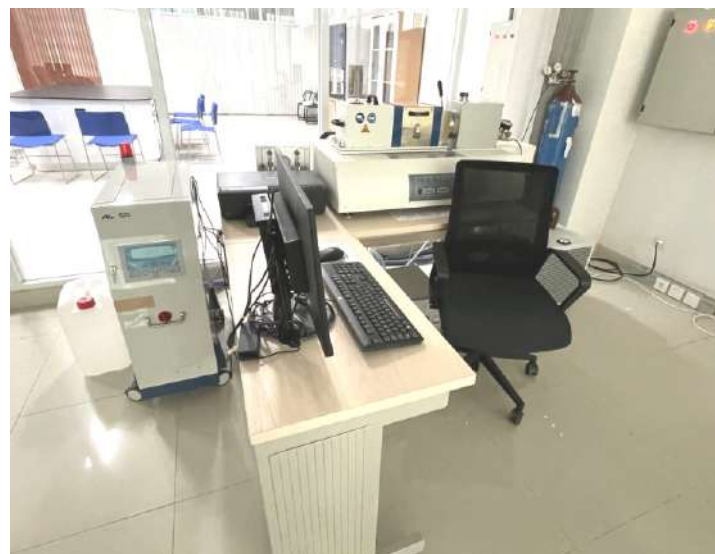
Linseis LZT-800 热电优值测量仪
